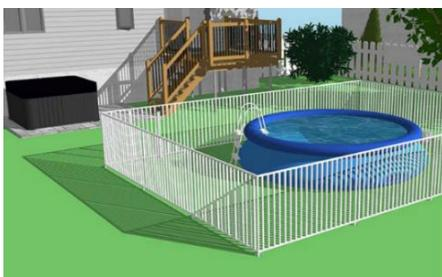
Exemple d'une piscine démontable de moins de 1,4 m de hauteur devant être entourée d'une enceinte.
